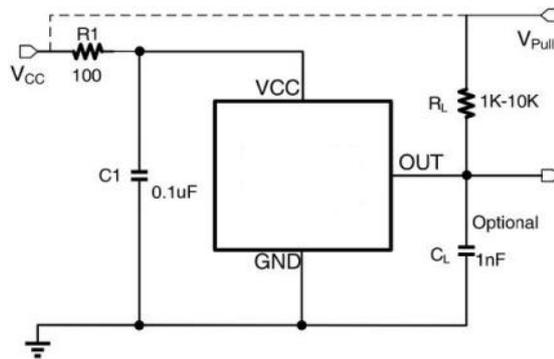
HEX34EW内部包含一个稳压器，可以在很宽的电源电压范围内工作。在应用中如使用非稳压电源，则必须在外添加瞬态保护。在使用稳压线路的应用中，可能仍需要EMI/RFI保护。R1用于改善CI性能，并且通常为100或200。HEX34EW是开漏极输出，其额定电流为40mA。为了正确操作，需要计算上拉电阻器RL的值。当输出拉低时，RL的大小是输出上升时间和负载能力之间的折衷。较低的电流通常更好，但是更快的转换和带宽(频率)需要更小的电阻来实现更快的切换。根据系统带宽规格为CL选择一个值，如下所示:
