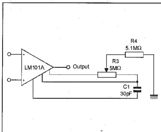
ALTERNATE BALANCING CIRCUIT
